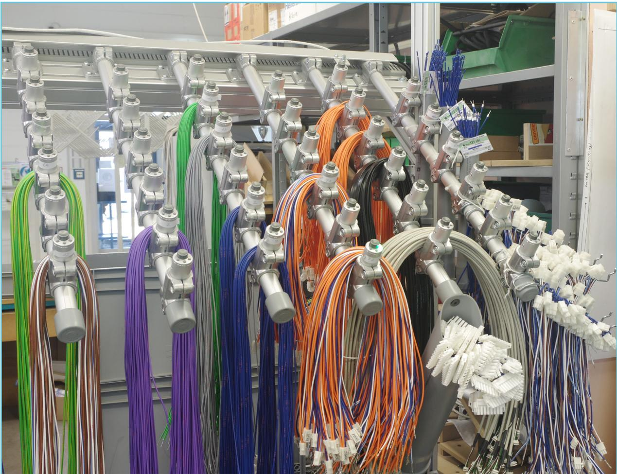
Das Programm von Kabelassistent W 12 auf dem Server steuert alle Pick-By-Light Funktionen und verarbeitet die Signale der Bestätigungstaster.
